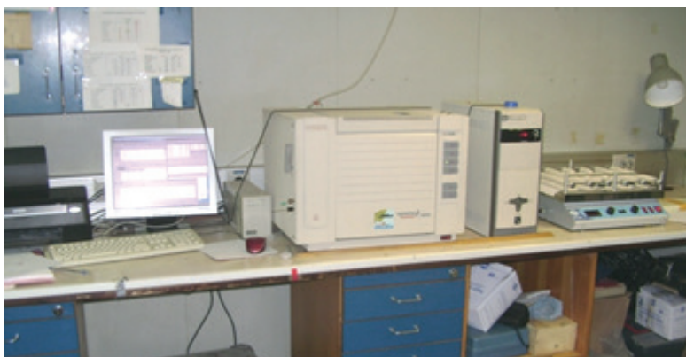
Рис. Система для газохроматографических измерений на борту судна: компьютер, газовый хроматограф «КристалЛюкс 4000М», генератор водорода, компрессор и перемешивающее устройство.
