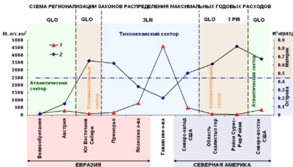
Рис. 1. Схема регионализации законов распределения и характеристик паводков в гумидном климате Северного полушария. Обозначения: (1) – средние из максимальных в году модулей стока рек, М, л/(с·км 2 ); (2) – коэффициент детерминации связи выборочных L-вариации и L-асимметрии рядов наблюдений, R 2 ; t – коэффициент L-вариации; t 3 – коэффициент L-асимметрии; GLO – обобщенное логистическое распределение; 3LN – трехпараметрическое логнормальное распределение; 3PIII – распределение Пирсона III типа
