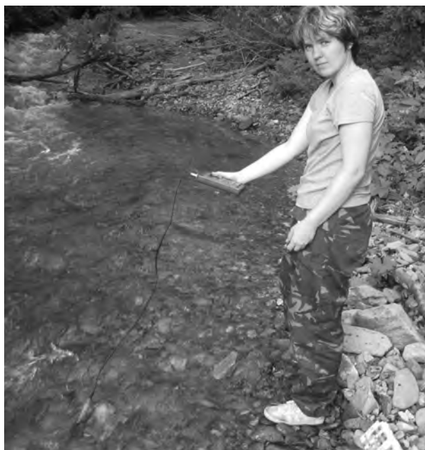
Измерение электропроводности. С.Г. Юрченко
