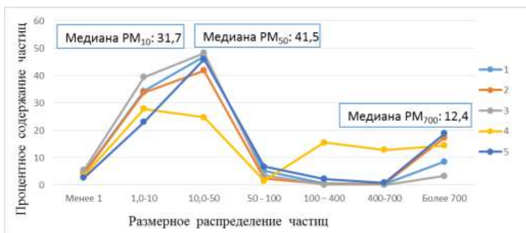
Рисунок 49. Гранулометрические кривые распределения атмосферной взвеси с. Чугуевка
