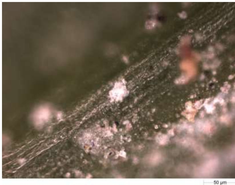
Рисунок 62. Микрофотография хвои из точки отбора проб №2, полученная на Morphologi G3-ID (увеличение 200 раз)
