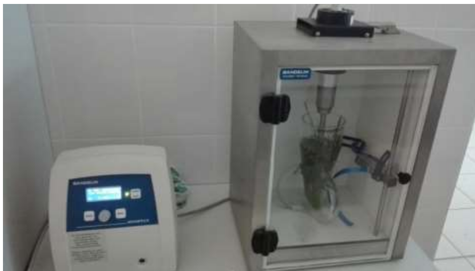
Рисунок 31. Процедура обработки пробы хвои ультразвуком
